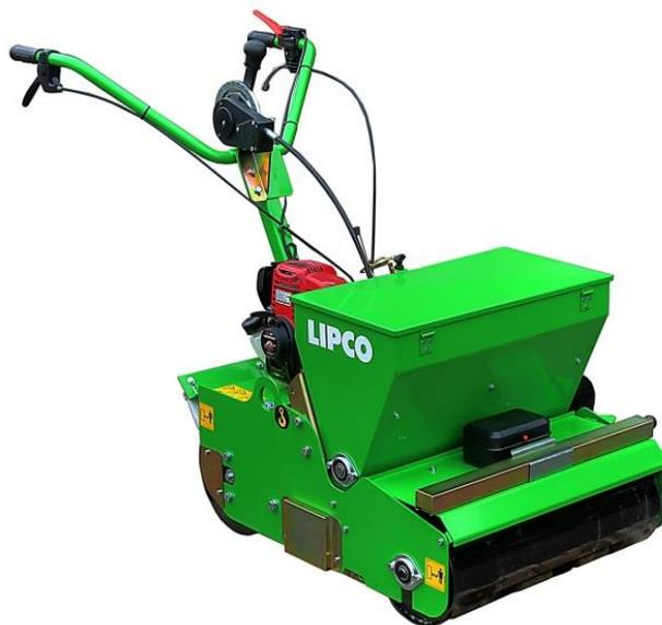
Die Rasenbaumaschine RM ist mit einem eigenen Antrieb ausgestattet. Somit wird kein Trägerfahrzeug benötigt.
